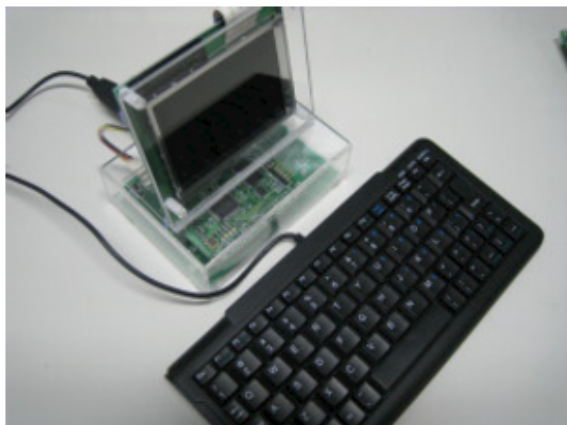
図 1 MieruPC2008 Rev.2 . 上がコマンドインタプリタ型液晶ディスプレイ, 下が FPGA カードを含む MieruPC 本体 . 本体には PS/2 キーボードと液晶ディスプレイが接続される .
