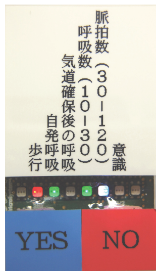
図 8 電子トリアージ・タグの入出力部
