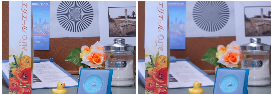
図 12 未較正合成開口法 8) によるぼけ生成の結果．左：5枚の入力画像のうちの1枚．右：未較正合成開口法により生成した背景ぼけ画像．色一緻度判定を用いることによりエッジ周辺のぼけが正しく再現されている．
