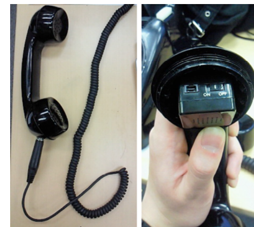
図5 受話器型スピーカーとその内部
