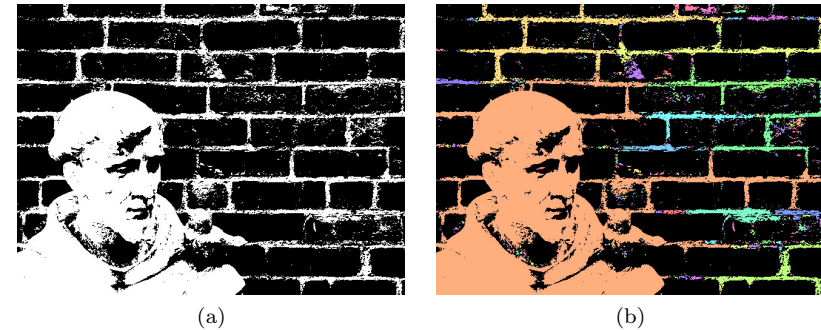
図 3 連結領域ラベリングの実行例 (a) 入力画像 (b) 実行結果 Fig.3 Result of connected component labeling (a) input (b) result
