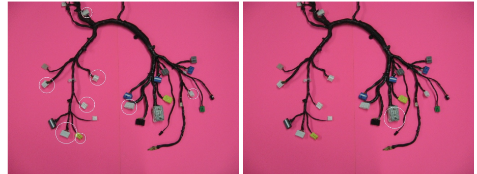
図 7 全 10 種のうち 2 種類のコネクタ C_1 , C_8 の検出結果 (左上, 右上, 左下, 右下の順). 白い円の大きさは検出スケールを示す.
