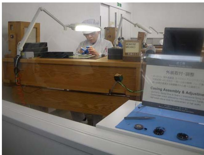
図4 時計の外装取付け工程
