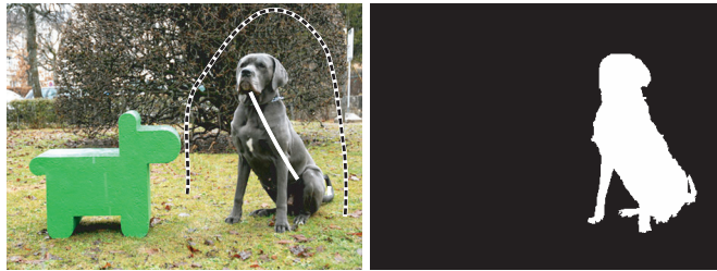
図 1 左：対象画像とユーザが入力した手書き線．実線が前景領域，点線が背景領域を表す．右：出力のマスク画像．白が前景領域，黒が背景領域を表す
