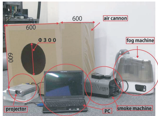
図 3 予備実験用プロトタイプシステム Fig. 3 Prototype system for preliminary experiment.
