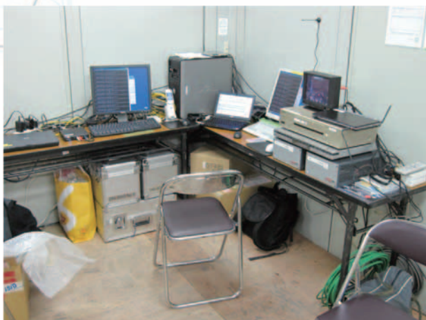
写真2 大通公園のプレハブに設置したワンセグ関係機材 (右手テーブル上の2台並んだ箱がワンセグ・ボックス)
