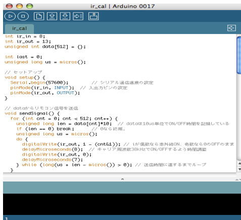
図 5 《Arduino IDE 内に施したプログラミング》
