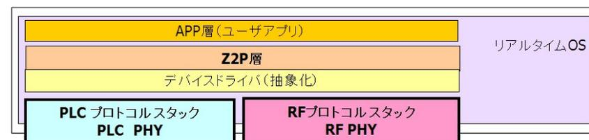
図2 PLC/ZigBee 相互補完通信プロトコル
