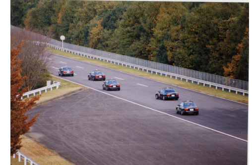
図 6 : 5 台の自動運転車両による協調走行
