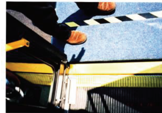
図 9: カリフォルニア PATH の自動運転バス; (左) 狭いレーンを走行中のバス, (右) プレジジョンドッキング (上がプラットフォーム, 下がバスの乗降口)
