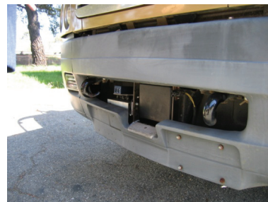
図 8: カリフォルニア PATH の自動運転トラックのセンサ類 (中央にレーダ, 左にレーザーレーダ)
