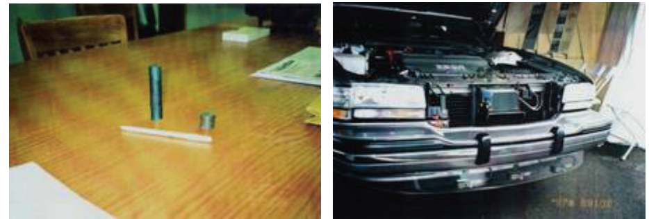
図 12 : (左) 磁気マーカ (2 種), (右) 磁気センサ (バンパ下) と車間距離測定用レーダ (中央)
