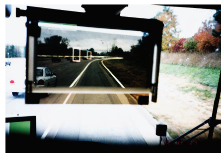
図 14 : GPS データと地図データベースから生成したレーンマーク
