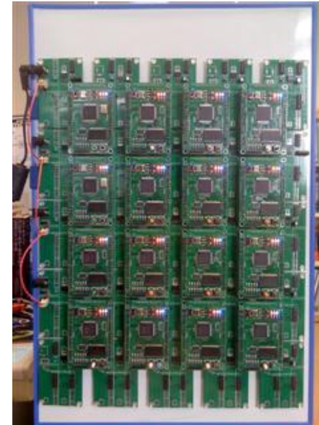
図 7 Board と Unit を接続し、4×4 の ScalableCore システムとしたところ。各 board 裏についている磁石を利用し、ホワイトボードを用いて縦に設置している。
