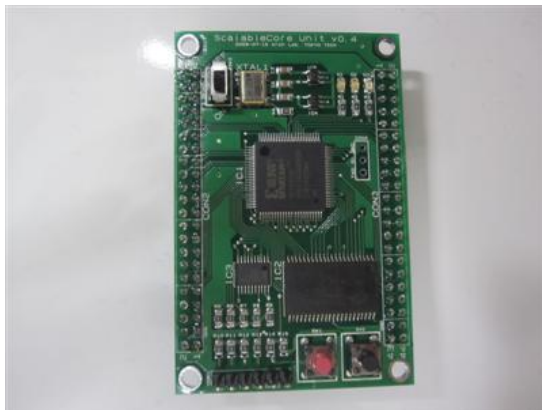
図 6 制作した ScalableCore Unit. FPGA チップは Xilinx XC3S500E
