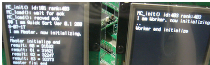
図 13 4 の ScalableCore システムで Quick Sort が実行されている様子。左がマスターコア (1,1) の出力, 右がワーカコア (4,3) の出力である
