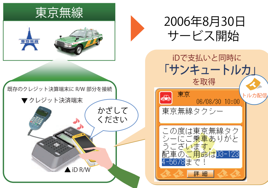
●図-6 タクシーでのケータイクレジットと携帯電話向け CRM ツールの連動イメージ
