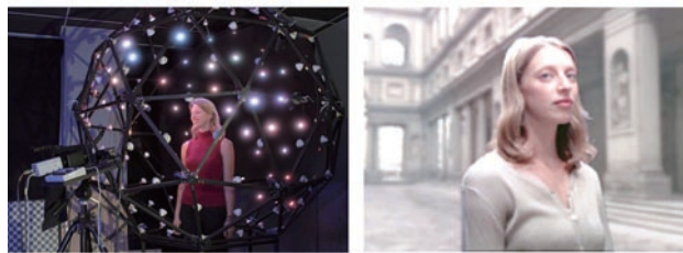
図-3 (左)色の変化する LED で俳優を何度も照射、 (右)撮影現場の照明に応じた CG の俳優を生成 (Paul Debevec 氏提供)
