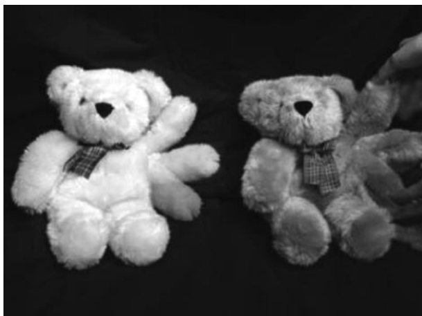
図-4 RobotPHONE。ネットワークを介して小型人型ロボットを同期させて、ユーザがジェスチャを利用してコミュニケーションすることができます(関口、稲見)。
