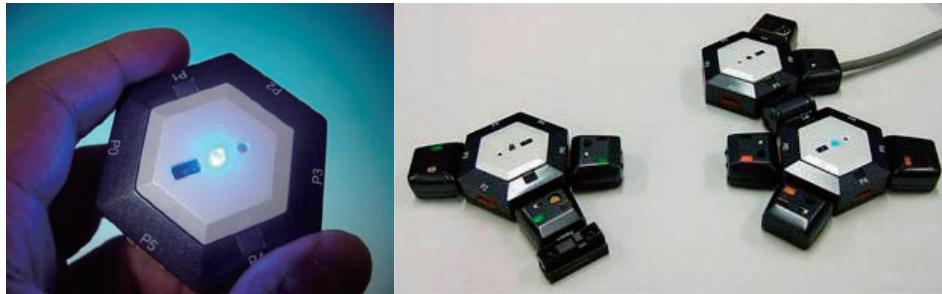
図-3 NEC・阪大グループによるユビキタスチップ AhroD. 数バイトでコーディングされたルールを数十個格納でき、格納されたルールにより IO やタイマ、通信の制御が行える。
