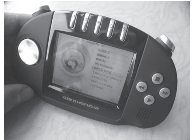
図-2 キズモンド。CPUは64bitのARM9 400MHz、OSがWindowsCE 4.2、グラフィックチップは128bit Goforce 3D 4500である。本体裏カバーを開けるとボーダフォンのSIMが入っている。
