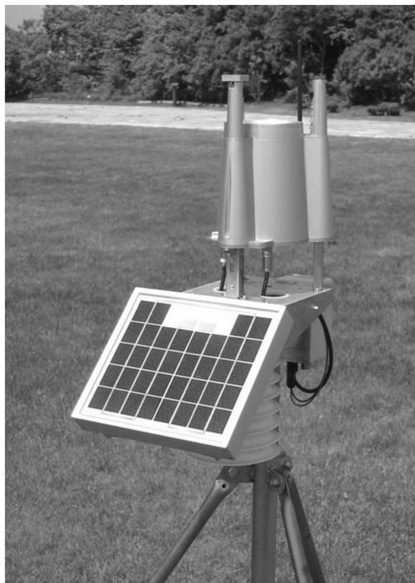
図-3 (株) エスイーシー製の電子百葉箱 WeatherBucket
