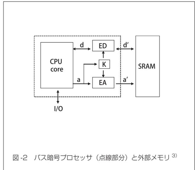
図-2 バス暗号プロセッサ（点線部分）と外部メモリ<sup>3)</sup>
