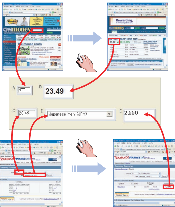
図-2 C3Wフレームワークを用いたWebページからの項目の抽出とそれらの機能連携(上段は企業の株価情報サービス,下段は為替変換で,Cセルを'='B'と定義することにより,ドル建ての株価を円建てに変換する連携が構築されている)
