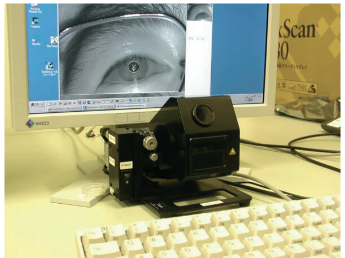
図-3 視線測定装置FreeGaze
