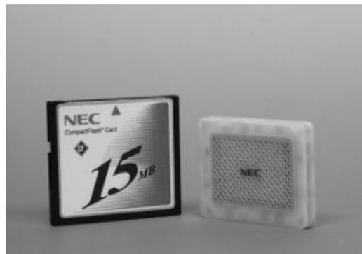
図-4 携帯機器用燃料電池の構造と試作品。30×4×5mmの大ききでコンパクトフラッシュカードよりもひとまわり小さい。
