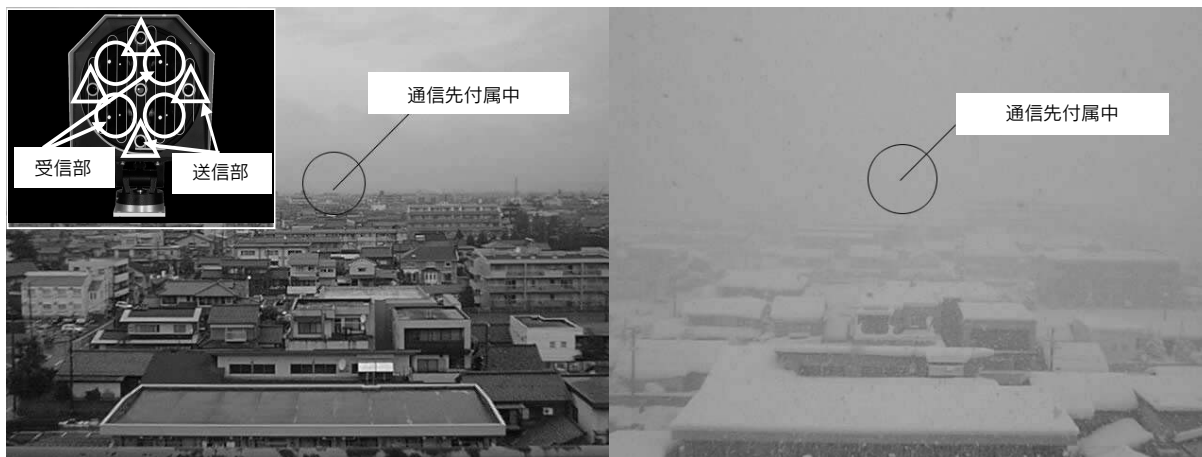
図-1 光無線LANシステムと通信先の中学校の見え方(左が晴天時、右が通信途絶時)
