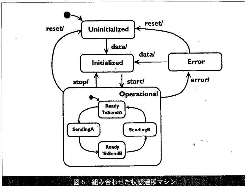
図5 組み合わせた状態遷移マシン
