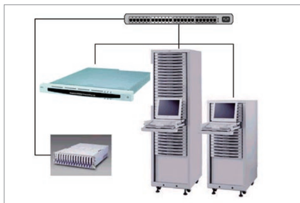
図-1 PC サーバ群が高速 LAN で接続されたクラスタ環境
