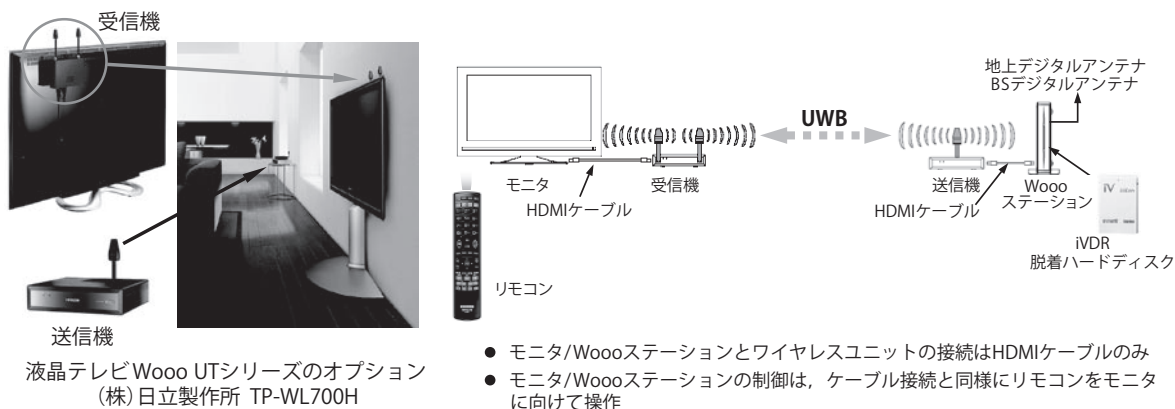
図-11 HDMIのワイヤレスユニットの例
