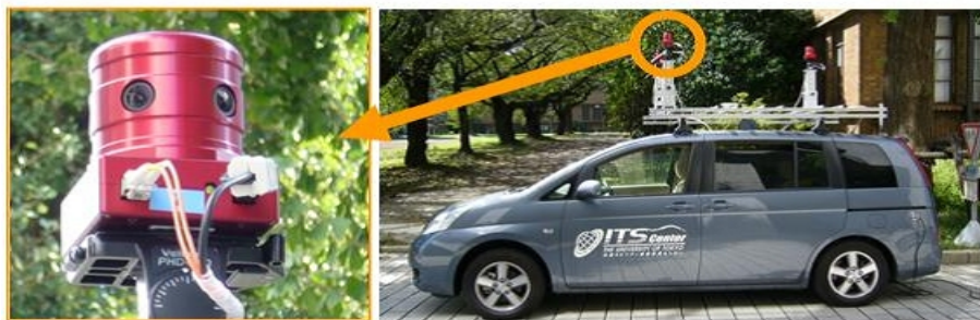
図 25 Ladybug2 と計測車
