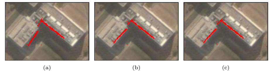
図 7 図 6 の 3 次元復元結果を上から眺め, Google Map の画像に重ねたもの. (a) 金谷・三島 9) の方法. (b) 本システムの平均焦点距離の方法. (c) 本システムの固定焦点距離の方法.
