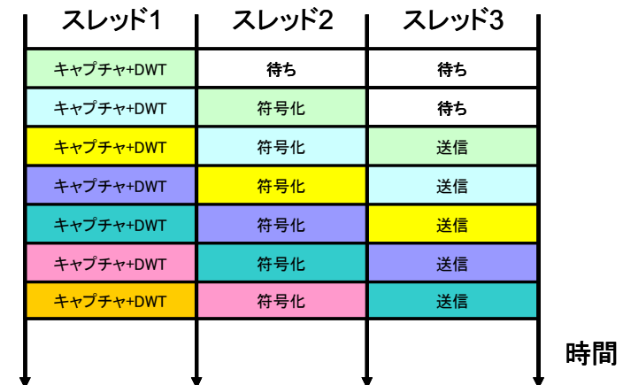
図3 送信側処理のマルチスレッド化による効率化
