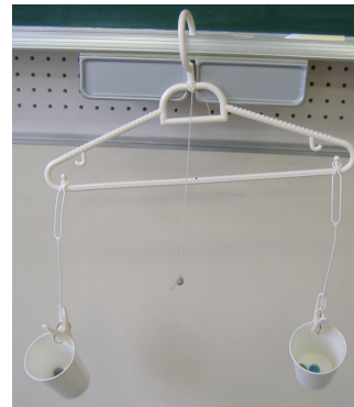
図 3 ハンガー・洗濯ばさみ・紙コップ・ビー玉を用いた天秤
