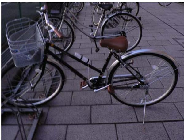
図 2 センターフレームに取り付けた振動センサー（Wii リモコン）
