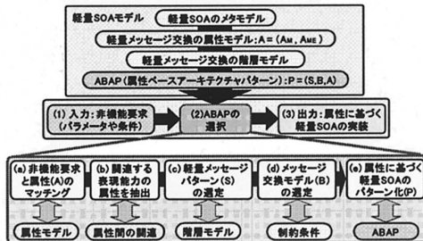
図 11: モデルとパターンに基づく軽量 SOA 設計プロセス
