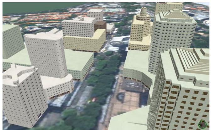
図1 本システムで自動生成した3次元都市モデル(シンガポールの街並み)
