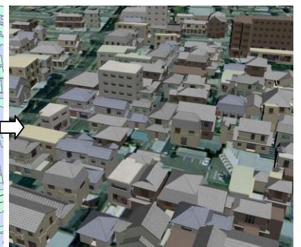
図3 電子地図に基づいて自動生成された3次元都市モデル
