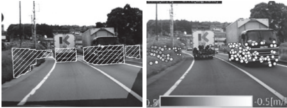
左図：障害物検出結果（斜線：障害物、明るく示す領域：道路領域）。 右図：奥行き方向の絶対モーション推定結果。手前に迫る動きほど白色に対応。○の大きさは距離に対応している。
