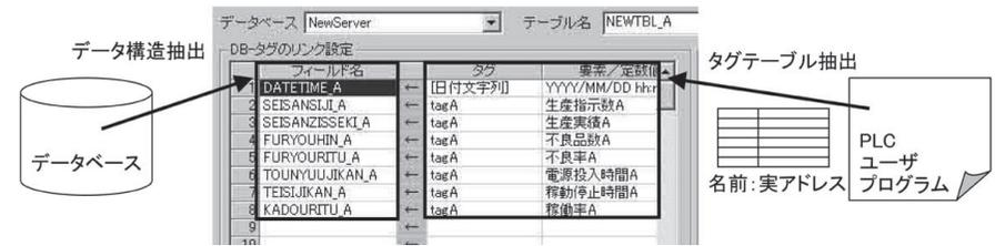
図6 フィールドへの装置内データの割付け
