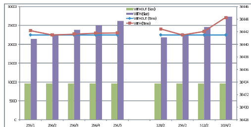
図 12 ハッシュ数あるいは配列長の増加に対する転送量と処理時間 (Query 14, サーバ数 15)
