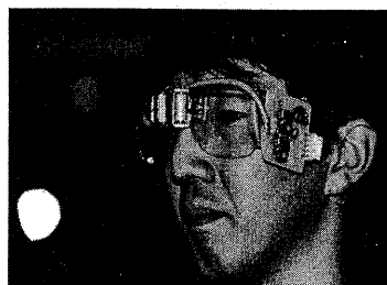
図8. 周波数下降型コウモリをモデルとした超音波メガネ
