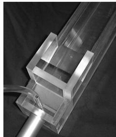
Fig. 6: モデルパイプに付けられた box ear
