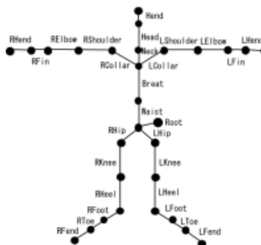
図 5 標準骨格構造
