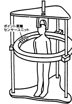
図2.1 ポイント距離センサによる人体の3次元データ入力装置
