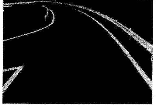
図-11 白線検知TVカメラ入力画像
