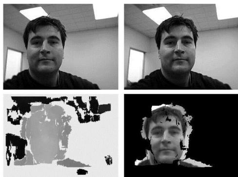
図7：小型ステレオカメラによる画像処理例（上段：左右のカメラからの入力映像。下段左：算出された距離画像。下段右：背景から切り出された人物画像。下段右の画像から人物の識別などを行なう。）
