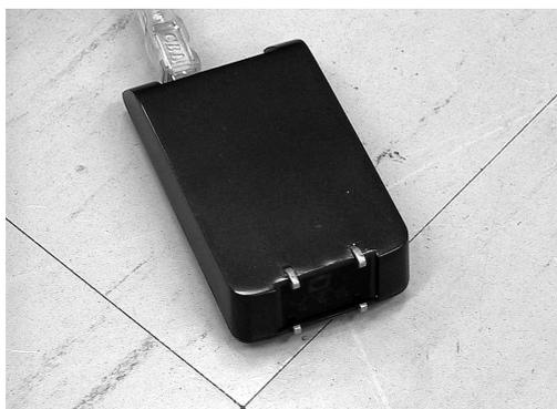
図8：通信デバイス（汎用リモコン。エージェントと家電などの通信に利用している。制御対象の識別信号を受け、それに対応した制御信号を発信する。）
