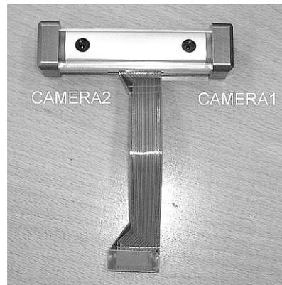
図6：小型ステレオカメラ（携帯エージェントシステムのディスプレイ上部に取付けて利用している。CPUにPentiumIII,850MHzを使った場合、320x240ピクセルの
