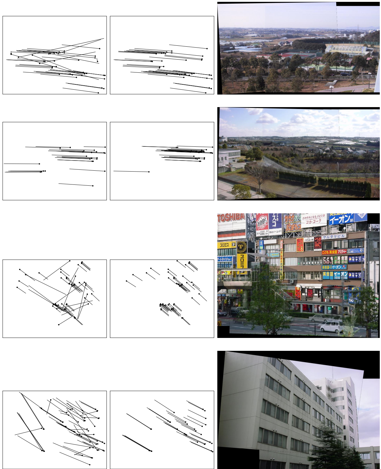
図 5: 左から順に図 1~4 で得られた対応, それからロバスト推定で得られる対応, およびそれから生成したモザイク画像.
