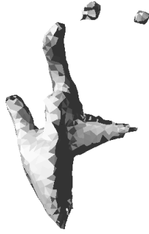
図 6: 把持物体によるオクルージョンの影響の大きい復元データ
