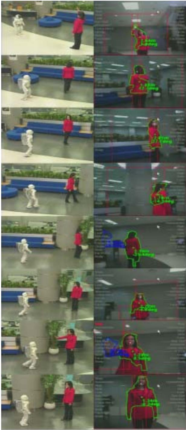
図6 ポスチャを認識して追従開始, 移動体抽出による追従, 停止のポスチャを認識して停止. 左; 俯瞰図, 右; 画像処理結果.
