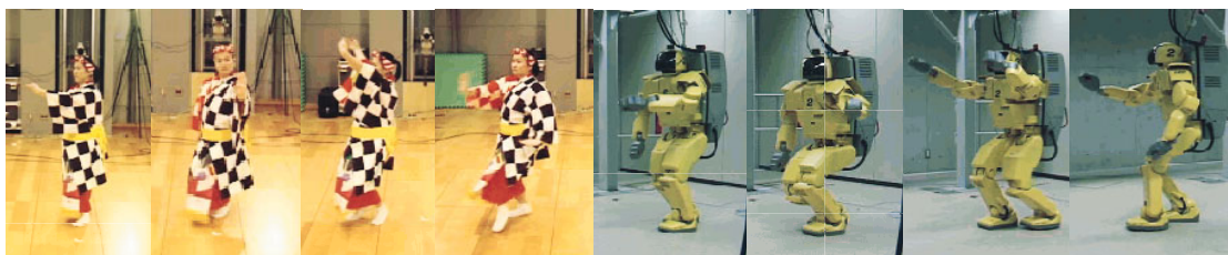
図 1 人間の動作とロボットの模倣動作（津軽じょんがら節）
