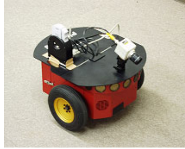
図 9 今回使用したロボット (ActivMedia Robotics 社製の Pioneer3 DX-8)
