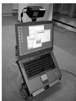
図 14: DP200 を搭載したロボット ER1
